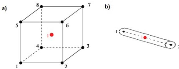
Figure 14. a) C3D8R element b) T3D2 element.
