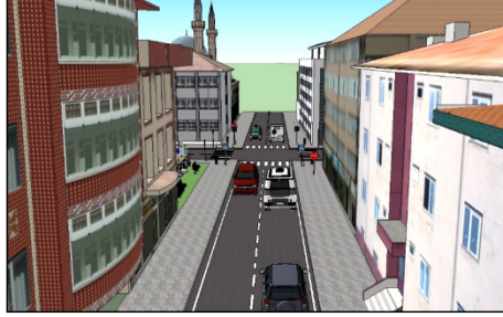
Şekil 11. Şehirçi yol daraltma uygulaması örneği
