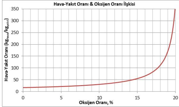
Şekil 2. Hava-yakıt oranı ile oksijen oranı arasındaki ilişki
