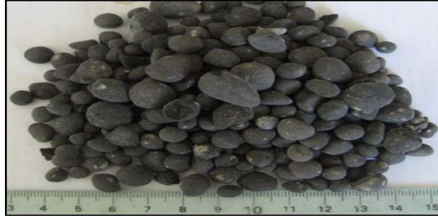
Şekil 3. %20 RDF + %80 LPG kullanılarak üretilen klinker numunesi
