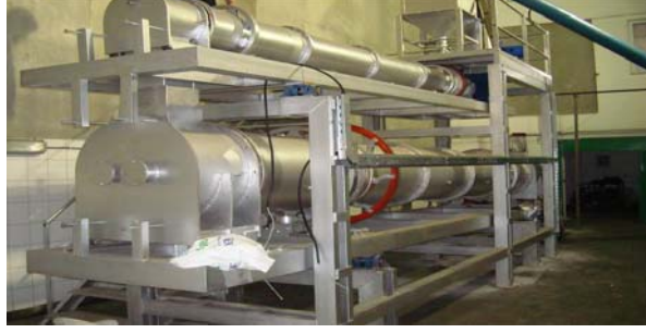
Şekil 2. Pilot çimento döner fırını
