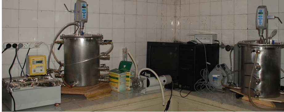
Şekil 2. Havasız çürütme prosesinin görünümü [13]
